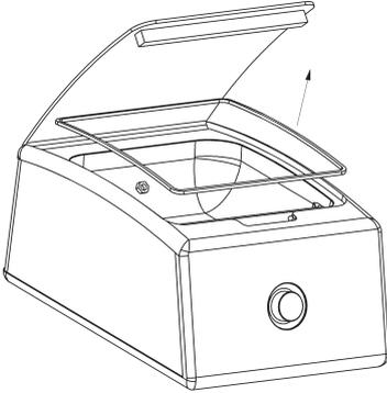
1. Die Kammerdeckeldichtung aus der Nut herausziehen.
