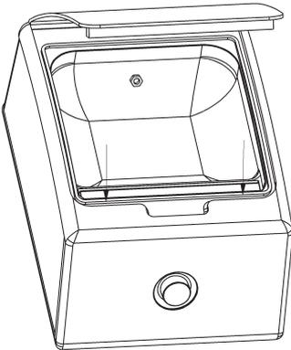
2. Die Kammerdeckeldichtung in die Nut drücken. Dabei die Kammerdeckeldichtung nicht in die Länge ziehen. Die Öffnung der Kammerdeckeldichtung zeigt nach innen.
