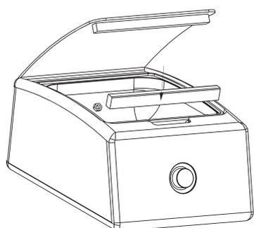
2. Die neue Siegelschiene in die Maschine stecken. Die halbrunde Öffnung zeigt nach hinten.
