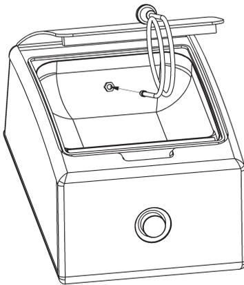
2. Stecken Sie den mitgelieferten Vakuumschlauch in die Vakuumöffnung.
